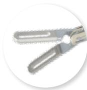
Gracias a la superficie de sujeción acanalada, el tejido se sujeta firmemente. Además de la coagulación precisa por AF de vasos y estructuras, la pinza laparoscópica bipolar es adecuada para la disección roma. La mecánica de doble acción abre las ramas uniformemente y sujeta el tejido mediante una presión de compresión uniforme.
