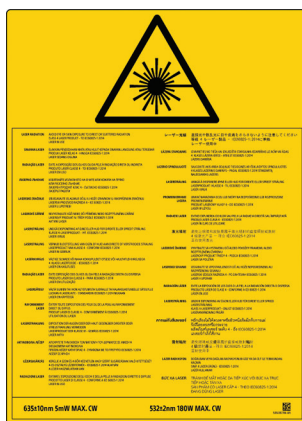
Figura 1. Sinal de advertência sobre o laser
